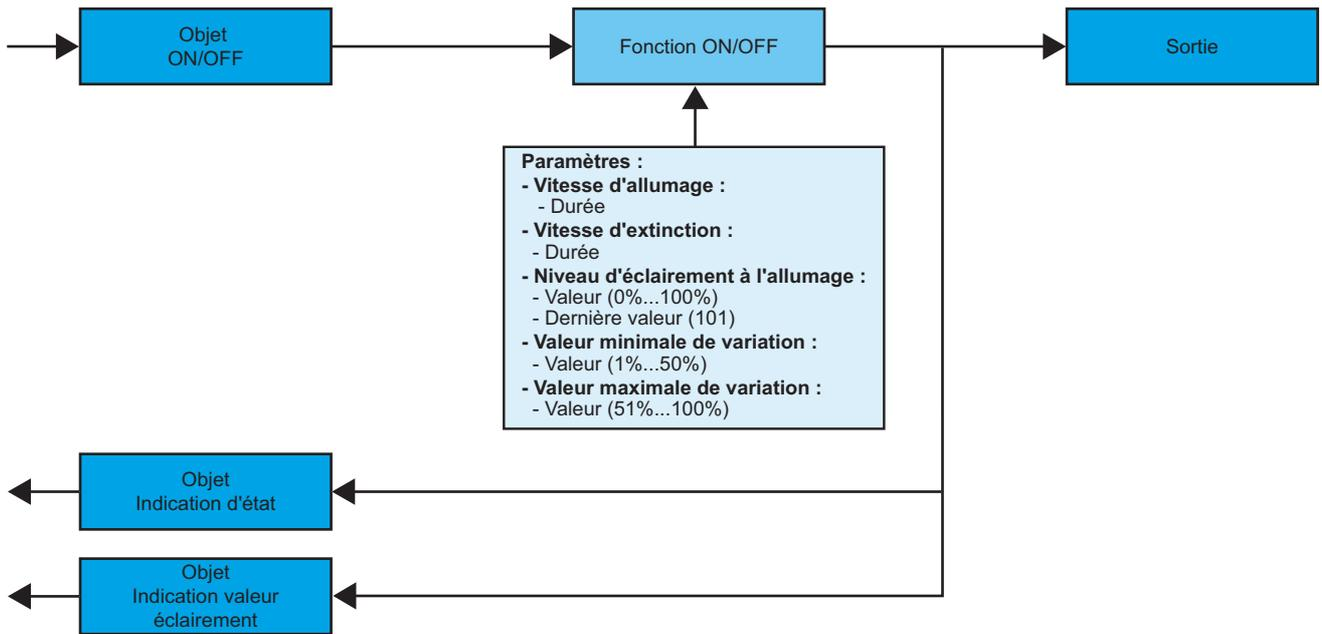
→ Principe de fonctionnement
