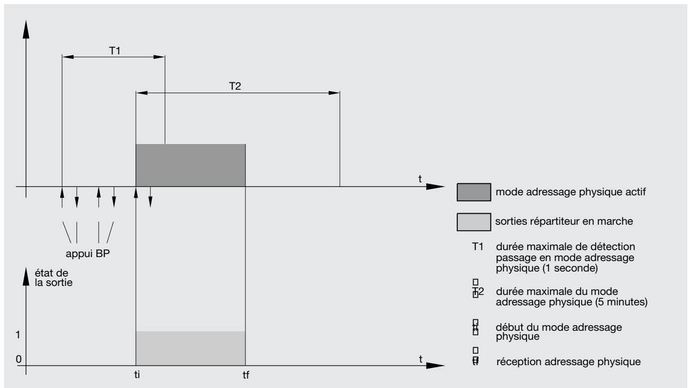
Pour passer le répartiteur en mode d'adressage physique, il faut 3 transitions successives sur l'une des entrées du répartiteur dans un délai inférieur à 1 seconde (T1). Le passage en mode adressage est visualisé comme suit :
