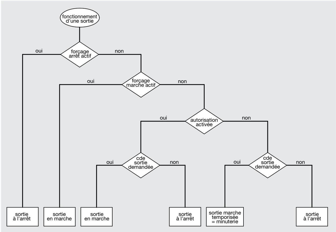
Le logiciel d'application permet différents modes de fonctionnement pour les sorties d'un répartiteur TC 124; les différents modes de fonctionnement sont activés/désactivés via le réseau de communication :
