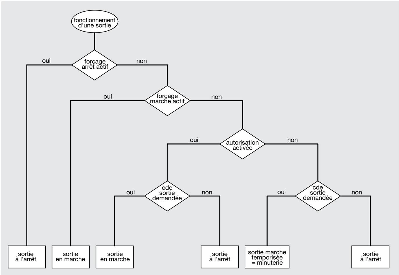
Le logiciel d'application permet différents modes de fonctionnement pour les sorties d'un répartiteur TC 033; les différents modes de fonctionnement sont activés/désactivés via le réseau de communication :
