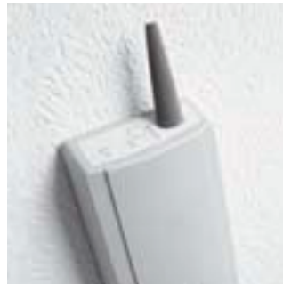
TX 100: Den nye bærbare programmeringsenheten. Via radio og radiogrensesnittet som er direkte tilknyttet din tebisinstallasjon, kan du i hvert enkelt rom programmere og tilpasse de enkelte funksjoner. Programmet lagres på et Smartmedia minnekort.
