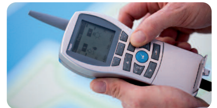
Draadloos KNX Easy mode programmeerapparaat (met project USB-stick) kan de installatie overal ter wereld aangepast worden
