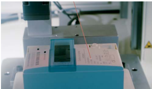
Manipulationssicher: Herkunftsnachweis durch Laserbeschriftung
