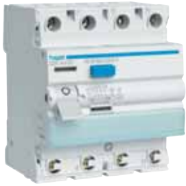
Bild 1.1: Beispiel einer Fehlerstrom-Schutzeinrichtung (RCD), Typ A zur Auslösung bei Wechselfehlerströmen und pulsierenden Gleichfehlerströmen mit einem Bemessungsdifferenzstrom 30 mA vierpolig, zum Einsatz in Wechselstromkreisen nach DIN VDE 0664-10 / EN 60008-1.
