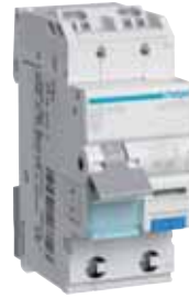
Bild 1.3: Beispiel einer Fehlerstrom-Schutzeinrichtung vom Typ A zur Auslösung bei Wechselfehlerströmen und pulsierenden Gleichfehlerströmen mit einem Bemessungsdifferenzstrom von 30 mA und eingebauter Überstrom-Schutzeinrichtung mit einem (Überstrom-)geschützten Pol (B16) als FI/LS-Schalter (RCBO) zweipolig, zum Einsatz in Wechselstromkreisen nach DIN VDE 0664-20 / EN 60009-1.
