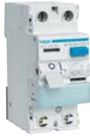
Bild 1.2: Beispiel einer Fehlerstrom-Schutzeinrichtung (RCD), Typ A zur Auslösung bei Wechselfehlerströmen und pulsierenden Gleichfehlerströmen mit einem Bemessungsdifferenzstrom 30 mA zum Einsatz in Wechselstromkreisen nach DIN VDE 0664-10 / EN 60008-1.
